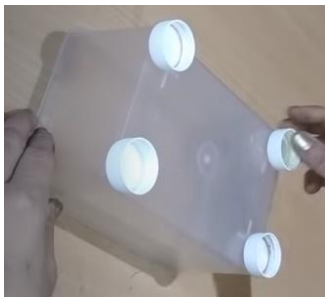
Slika 1: Lepljenje zamaškov – podstavkov
