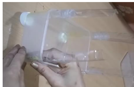
Slika 2: Lepljenje trakov v notranjosti posode
